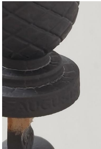
Zirbelnuss wird mit Grafit beschichtet, Kanten sind nicht sauber
